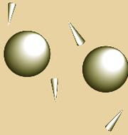
**2** 水の蒸発によって反応硬化が始まり、水性化アクリル樹脂が相互に結合。
