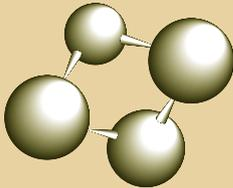
**3** 水性化アクリル樹脂の粒子間の反応硬化により、強力な三次元構造塗膜が完成。
