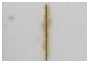
変性エポキシ樹脂系さび止め 60μm × 2回塗り(120μm)
