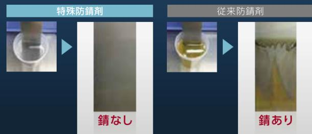
5wt%塩化ナトリウム水溶液に水性エポテクト下塗塗料に用いている特殊防錆剤を1wt%溶解させた塩水に鋼板を浸漬。
