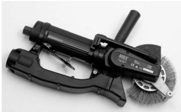
さび落とし又は塗膜除去作用は工具の回転あるいは往復運動によって行われています。直結式のものには工具部を駆動する電動機が一体となったものを操作しなければならぬので、重く、作業者の疲労度が大きくなるものが多い。これに対して工具部と駆動部とが別になり、回転軸をフレキシブルチューブに納めた形式のものは作業者の疲労度が少ない利点があるが、足場上でのフレキシブルチューブ取り回しにやや難があるうえに、フレキシブルチューブが消耗品とみなされる等のコスト的欠点があります。
