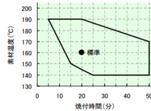
・電気熱風炉でのデータのため、ライン炉(ガス炉)での確認が必要です。
