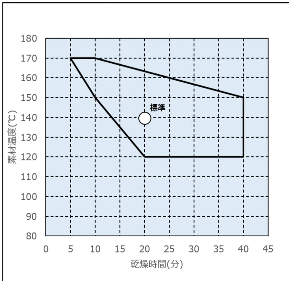
乾燥機： 電気熱風炉
