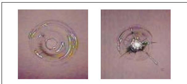
図2 合わせガラスの損傷例
