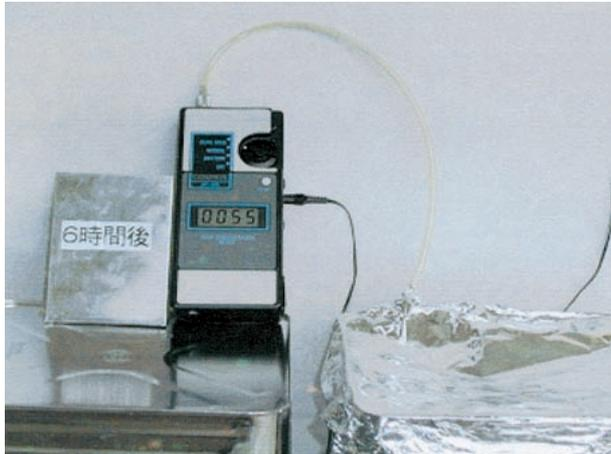
写真1 臭気測定試験の状況
