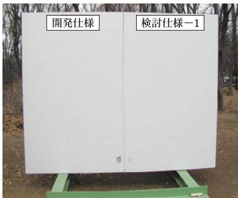
写真1 PCa板試験施工仕上がり
