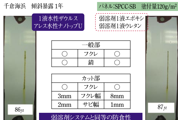
図10 海浜地域での屋外暴露試験結果
