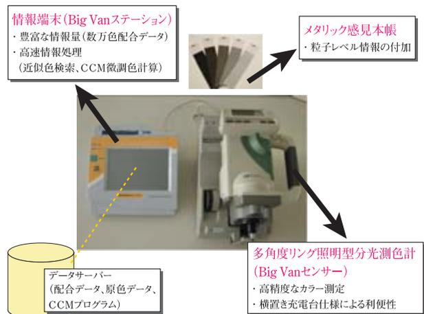
図3 BVセンサーシステム
