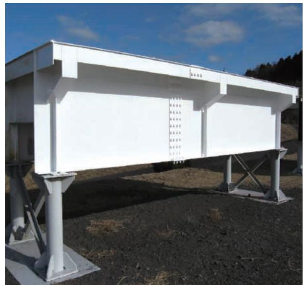
写真3 模擬橋梁試験体の全景
