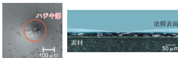
図11 塗膜のハジキ発生部の表面および断面の写真
