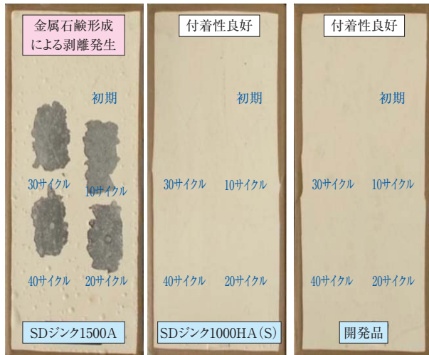
写真3 油性上塗りサイクル試験 (1サイクル:50℃プリスタボックス×16h+室温乾燥×8h)
