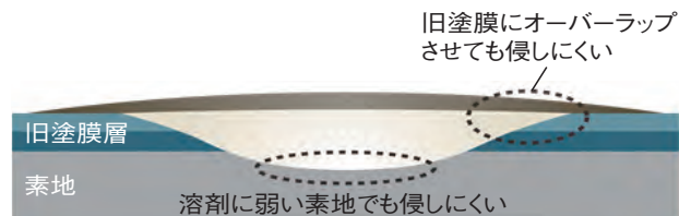
図2 パテ塗布後の塗膜断面
